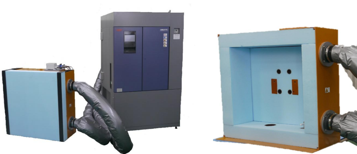
温湿度供給装置と試験ボックス
