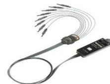
75MHz1000:1高電圧プローブ
