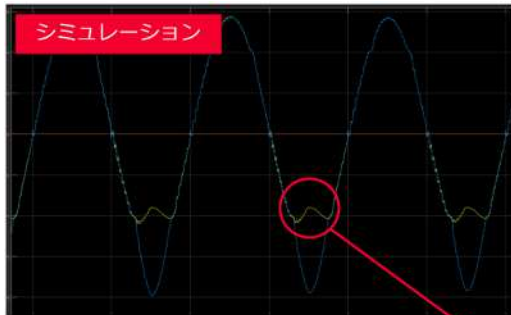
シミュレーションで見られる片相電流の大きな歪みが実機電流波形でも再現されている。
