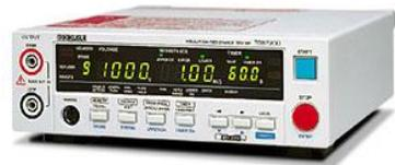
AC 5kV 耐電圧試験
