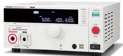
AC 5kV 耐電圧・絶縁抵抗試験器
