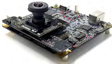
左図は SVM-06 の上に NV011-V、その上に OmniVision 社製の MIPI イメージセンサ (OV10640 ボード) を接続した状態です。
