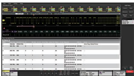
I2C、SPI、RS-232などのコンピュータ・バス、CAN、CAN FD、LIN、FlexRay、SENTなどの車載バス他、USBやEthernetなど、豊富なシリアル・バスに対応。プロトコル・デコード、サーチにより、シリアルバス解析が容易に。
