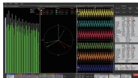
入力、出力、リップル、3つの主要な三相電気測定を自動化。画期的なオシロスコープベースの位相図に加え、同時にドライブの入力／出力電圧と電流信号を時間軸で観測可能。三相設計のデバッグに最適。
