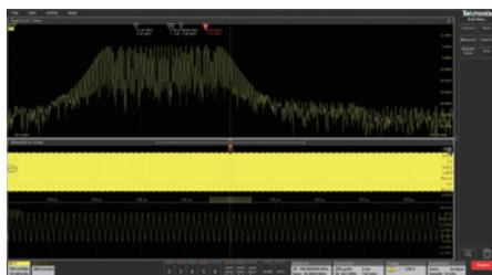
Spectrum Viewのオプション機能、RF対時間のハードウェア・トリガを追加。RF信号の挙動を簡単に分離、捕捉し、検査可能。RF振幅対時間やRF周波数対時間のエッジ、パルス幅、およびタイムアウトでもトリガ可能。
