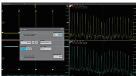
FFTと異なる画期的なスペクトラム解析機能、Spectrum Viewにより、効率的なスペクトラム解析が可能。時間ドメインと周波数ドメインの同時表示や、多チャンネル・スペクトラム解析も可能。取込み帯域拡張オプションで500MHzに拡張。
