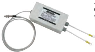
インパルスノイズ試験器のパルス出力を試験器内部の CDN を通さずに直接印加するためのユニットです。ボックス内部に CDN と同じカップリング用のコンデンサを内蔵しています。
