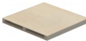
床置き機器に対する静電気試験を行なう際に、機器をグラウンドプレーンより 10cm 浮かすために使用します。
