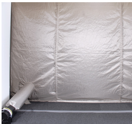
正面扉 シールドテント 閉口時
