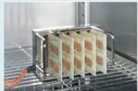
●絶縁抵抗/漏れ電流評価システム
