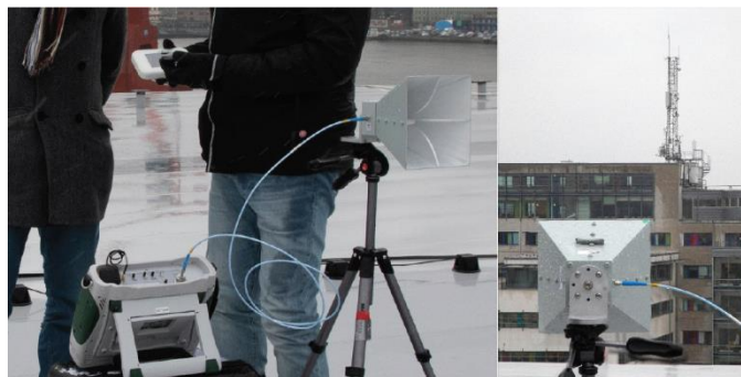
クワッドリッジホーンアンテナを用いた置局後基地局の実測例
