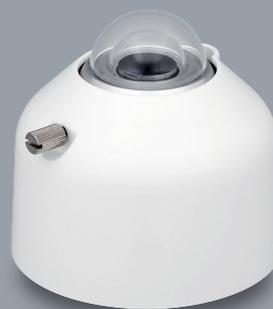
気密性の高い軽量なアルミ製ボディを採用し、内部結露や劣化が生じにくく安心してご使用いただけます。気密性試験は、全数検査を行っています。また、二重ガラスドームの採用により、ゼロオフセットを低減しています。EKO のクラス B 全天日射計は、気象庁の地上気象観測ネットワークでも使用されているほか、太陽光発電設備の大量導入時の電力系統への影響評価を行った「電事連プロジェクト (PV300)」で全国の電力会社に納入された実績のある日射計です。オプションのファンヒーターユニット MV-01 や、4-20mA 電流出力及び RS-485 デジタル出力に対応した信号変換器内蔵の S タイプも、MS-80 同様にラインナップされ、多様な日射計測に対応可能です。
