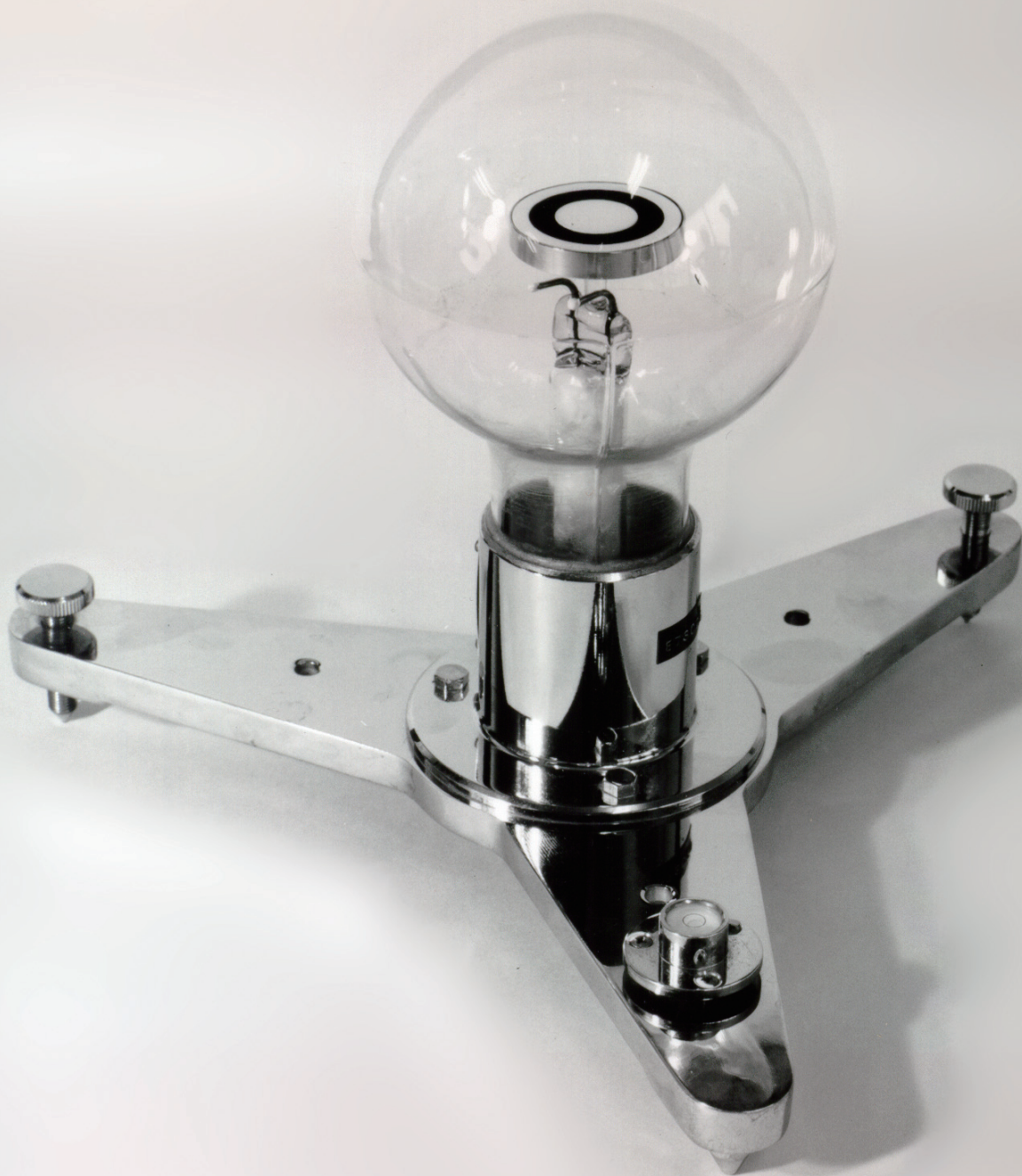
全天日射計 MS-22 1955年～英弘精機製造 分析機器・科学機器遺産 社団法人 日本分析機器工業会、一般社団法人 日本科学機器協会 2012年認定
