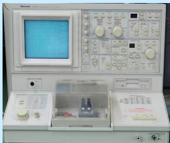
静特性設備 (カーブトレーサ)
