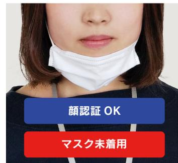
顔認証とともにマスクの着脱を判別し、マスク着用の不備がある場合は、ディスプレイ上に表示および音声でお知らせします。口・鼻が正しくマスクで覆われているかを判別するため、正しいマスク着用の周知徹底にもつながります。
