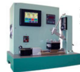
本試験機は、摺動面をはじめとして、材料の表面状態を摩擦力の測定によって評価するものです。
