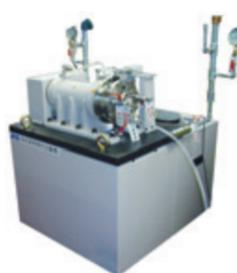
【仕様】加圧力15kN、回転数~10000rpm、焼付安全装置付き
