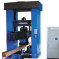
【仕様】最大荷重:300kN、下部支点距離:400~8100mm、支点までの高さ:約400mm、4点曲支点距離:200~2700mm
