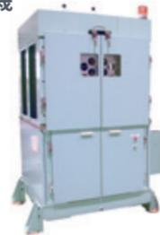
【仕様】最大加圧力:5kN、加圧設定:任意step加圧可能、滑り速度:1~500R.P.M.、滑り速度設定:任意step速度可能、摩擦力:50N・m、温度200°C、加熱方式:間接・直接加熱、運転パターン:JASOM349
