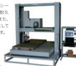
【仕様】耐久試験、ストローク:0~150mm、最大荷重:1.5kN、繰返速度:160回/min、測定点:ベッドの測定点を自動変更しながら試験可能、圧縮試験、試験速度1~500mm/min、最大荷重2kN
