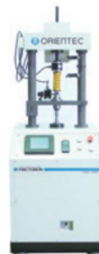
【仕様】最大加圧力:5kN、加圧設定:任意step加圧可能、滑り速度:1~400/sec、滑り即位度設定:任意step速度可能、摩擦力:100/200N切替、温度計測:最大3ch(op)
