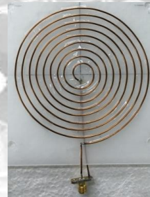
直径100mm 銅線コイル (銅線Φ=1mm)
