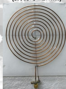
直径100mm 銅線コイル (銅線Φ=1mm)
