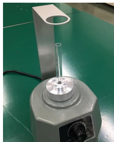
専用のバイブレータが付属 簡単操作で密に粉体を装填可能
