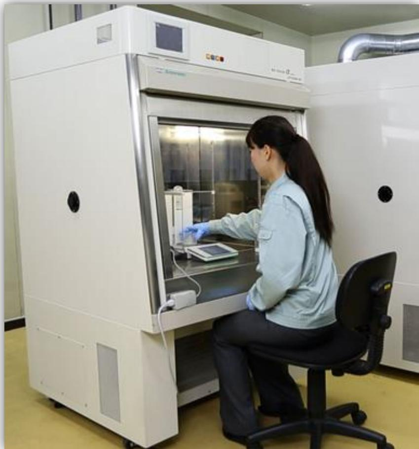
温度範囲 :  $-20^{\circ}\text{C} \sim +80^{\circ}\text{C} (\pm 0.5^{\circ}\text{C})$
