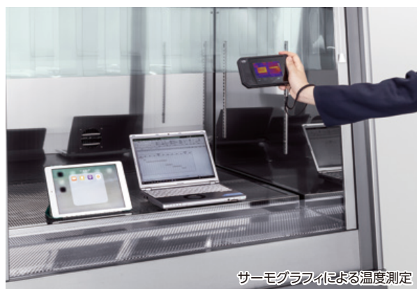
槽内試料の温度測定や撮影
