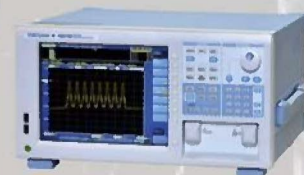
横河メータ&インスツルメンツ株式会社 光スペクトラムアナライザ AQ6370D
